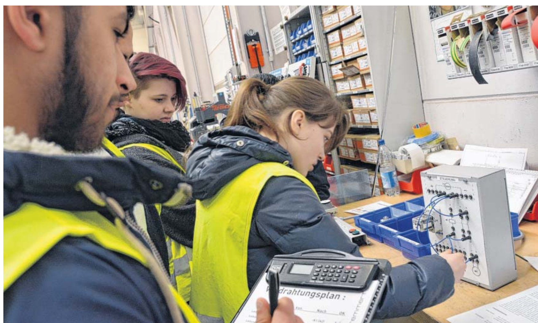
Das ist Teamarbeit: Belal (l., 18) liest vom Verdrahtungsplan vor, so dass Paulina (r., 15) die Kabel an der richtigen Stelle einstecken kann. Mit der Maschinensteuerung soll ein Transportband bedient werden. So konnten die Schüler bei der Firma Remmert selbst praktische Aufgaben lösen und ihr Geschick testen.
