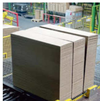
Das Endprodukt der 25 Jahre alten Maschine sind Wellpappebögen in individuellen Größen.
